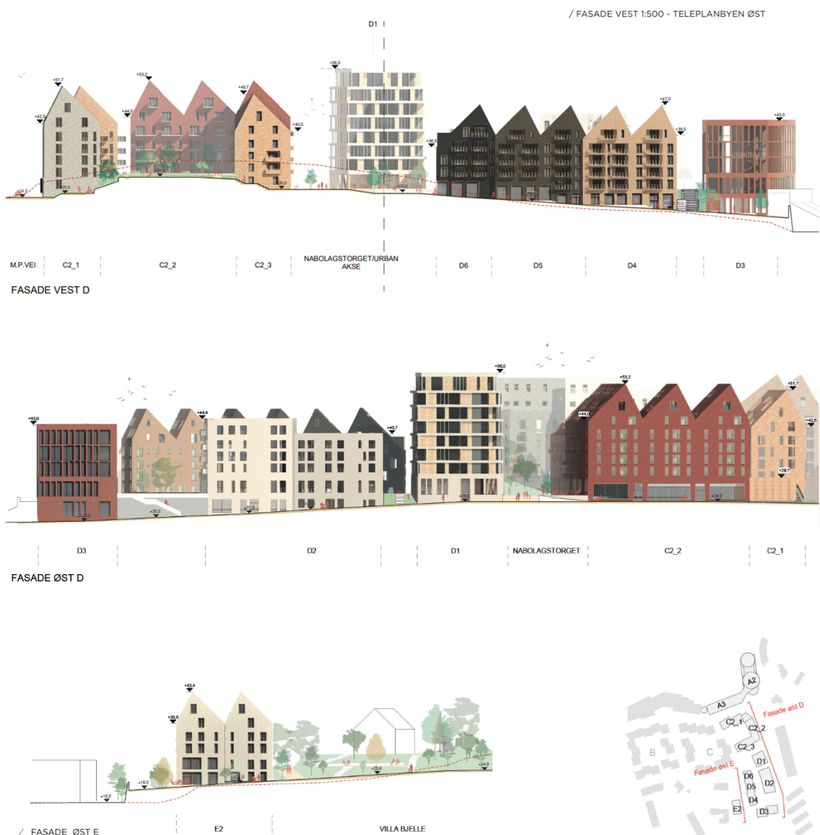
Figur 4-14 Bebyggelsen langs Fornebuveien og urban akse vist i fasadeoppriss. Viser en variert og oppdelt bebyggelsesom har høy grad av variasjon i materialbruk, høyder, takform og fasadeuttrykk.
