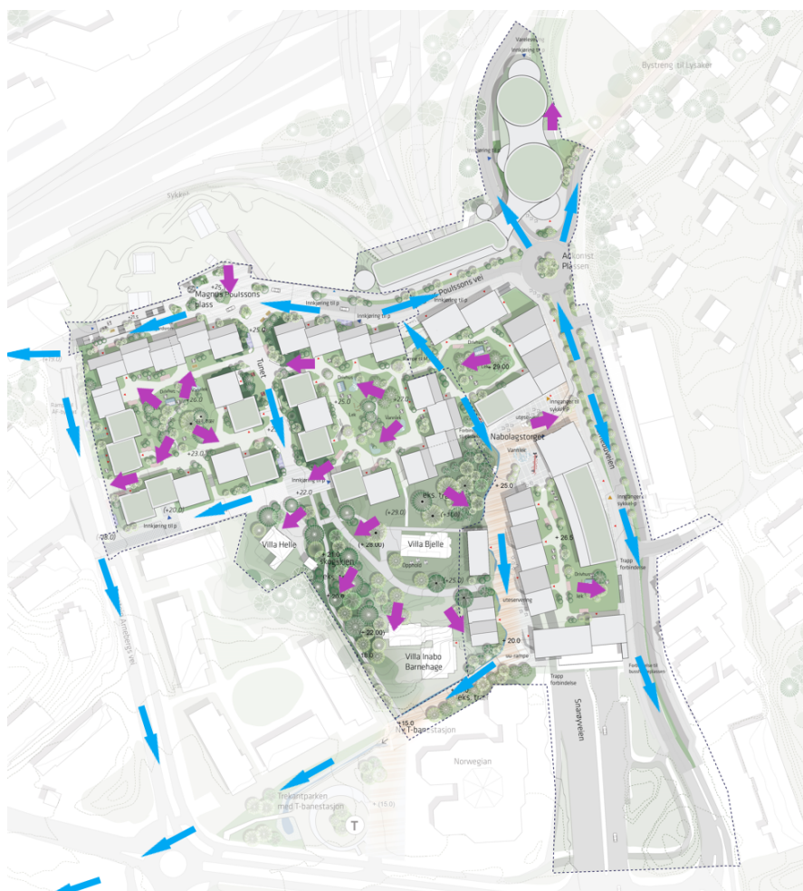
Figur 4-57: Avrenningsmønster fremtidig situasjon. Blå piler angir flomvei ved ekstremt regn. Lilla piler angir avrenningsmønster fra utbyggingsfeltene.
